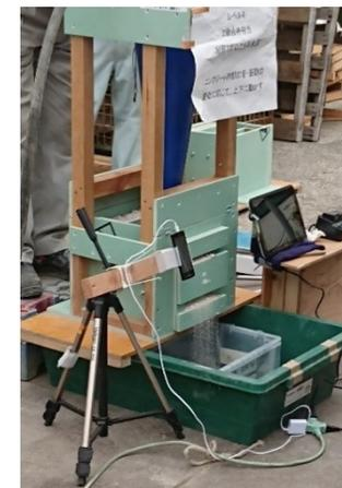
生コンと砂の音と振動の変化の相似を実験を行い確認する
