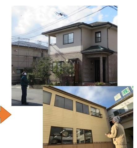
赤外線カメラ搭載ドローンを使った 地上からの外壁調査 安全な場所での効率的作業
