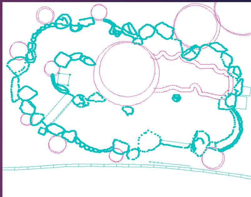
各点を測量し、池の大きさや各点の配置を確認し、各材の必要長さを概算で求め、どの場所をどう配置するかを検討した。
