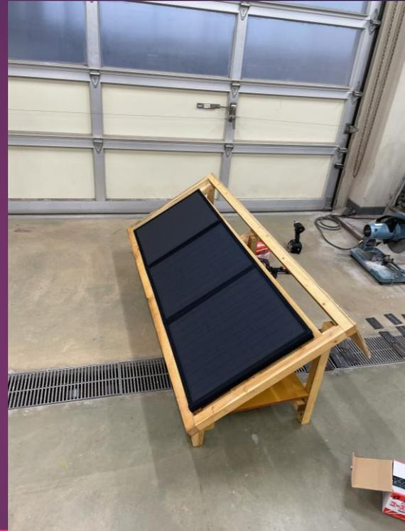
予算の都合上、屋外用のパネルは購入できなかったため、キャンプ用のパネルを屋外用へ改造し、蓄電池等の各制御装置を置くための小屋と兼用にして製作した。
