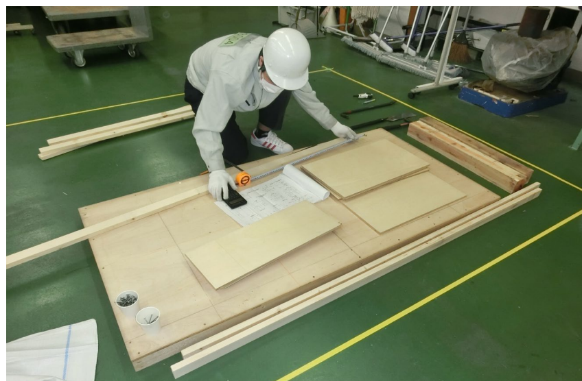
墨出し作業（作業開始）
